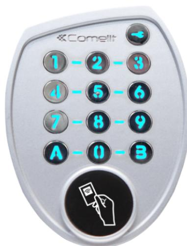
Clavier à codes en zamak, 100 codes de 3 à 6 caractères, touches rétroéclairées. Avec lecteur de proximité intégré. 500 badges, paramétrage par apprentissage . Relais paramétrables en mode monostable 1 à 99 secondes ou bistable. Gestion BP d'entrée, horloge et alarme. Gestion Wiegand. Ouverture par code ou par badge ou par code et badge Possibilité de relais externe. - 25°à+50° C, IP54, IK10. Dimensions 122 x 90 x 19 mm
